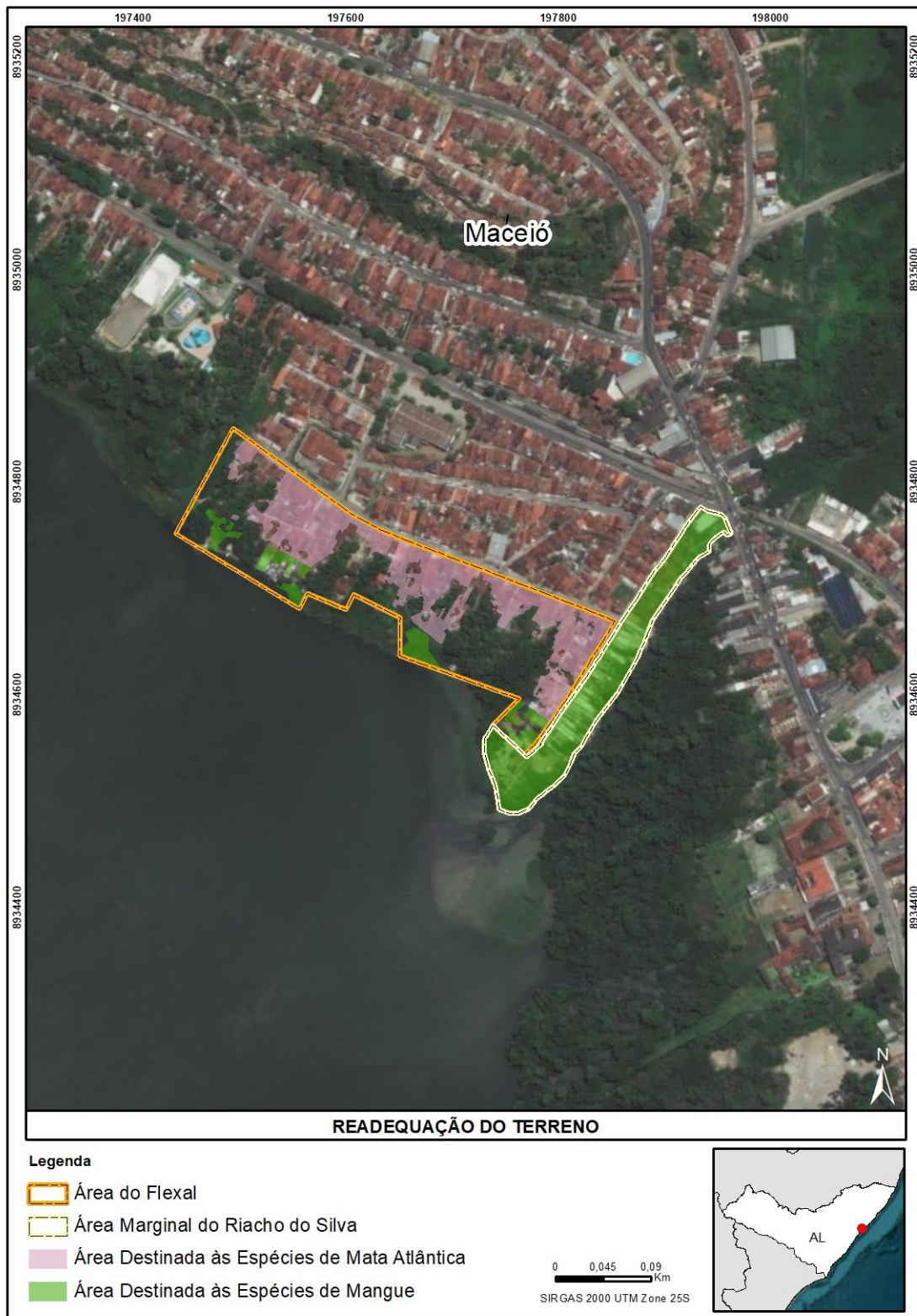
Figura1.8 - Polígono na cor laranja - Área Flexal e polígono na cor branca Área Marginal do Riacho do Silva onde as edificações foram demolidas, preservando vegetação existente. Em cor de rosa a área que receberá plantio direto, e em cor verde a área que será adequada para colonização de espécies de mangue.
